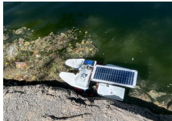
Figura 5. Dron en operación recolectando residuos flotantes durante una prueba en lago artificial.
