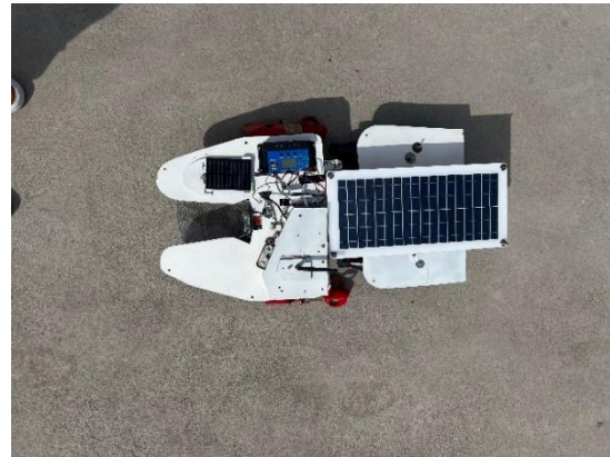
Figura 3. Versión final del dron acuático incorporando la estructura flotante con chasis modular, paneles solares frontales, pala recolectora y sistema de propulsión lateral.
