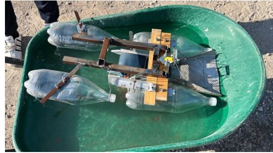
Figura 2. Sistema de flotación y estructura interna.
