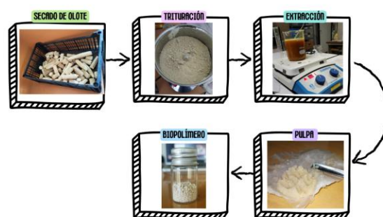
Figura 1. Proceso general de extracción del biopolímero del olote.
